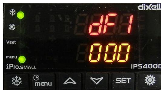
L'indice du circuit figure sur la première ligne tandis que la seconde ligne affiche le compte à rebours avant le démarrage d'un cycle de dégivrage.
