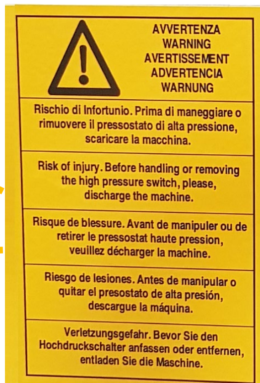
Figure 1 : Illustration d'un panneau avertissant de la nécessité de remplacer les pressostats haute pression lorsque l'unité ne contient pas de fluide frigorigène
