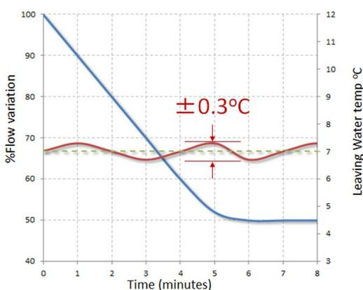
température de  $\pm 0,3^{\circ}\text{C}$  à la sortie de l'évaporateur.
