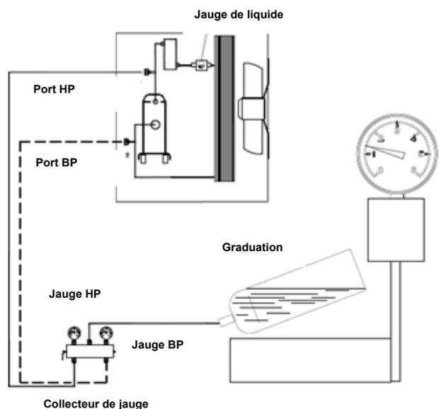
Charge de fluide frigorigène en phase liquide
