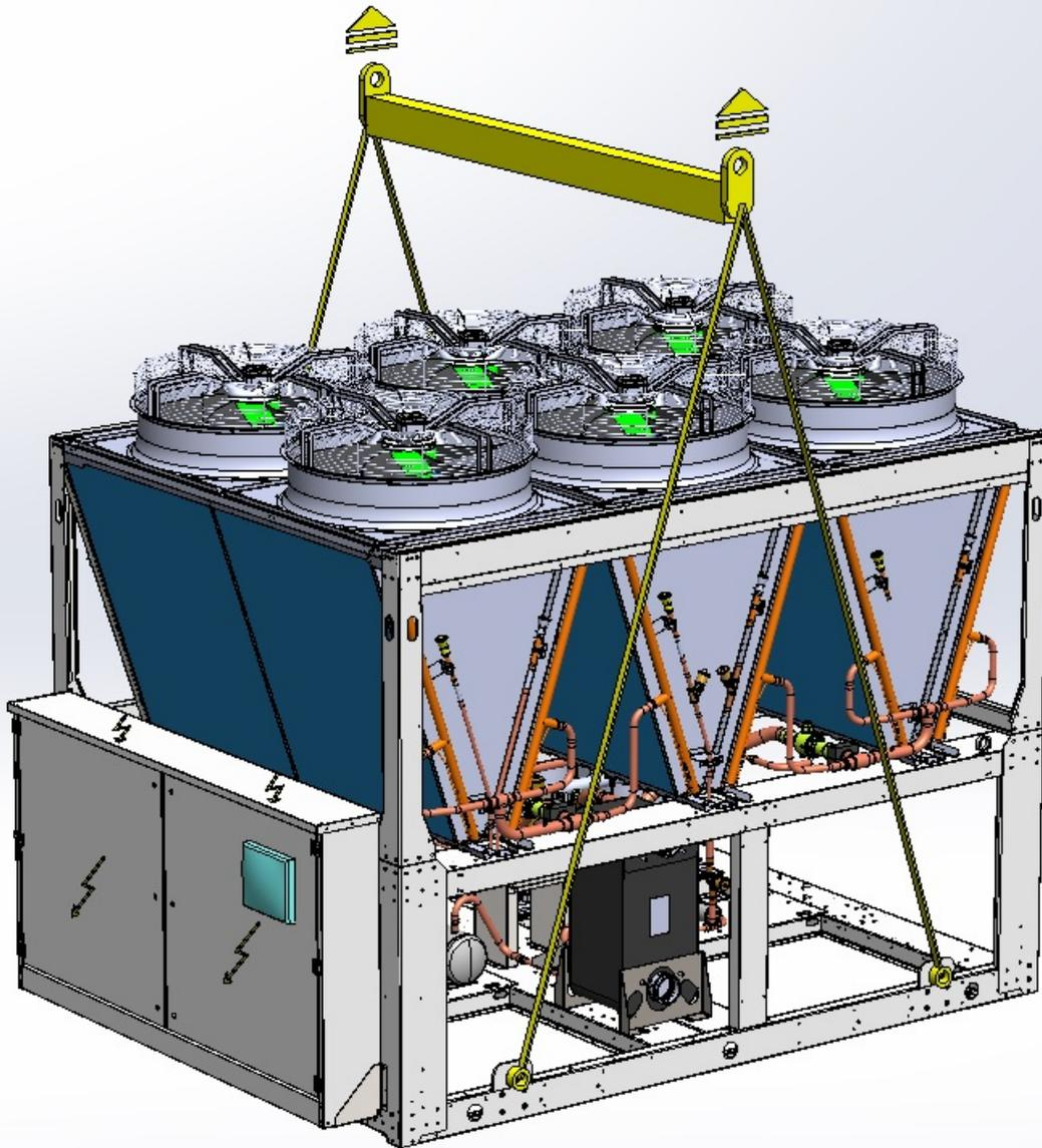
Illustration2b Procédure de levage correcte Version 3 V
