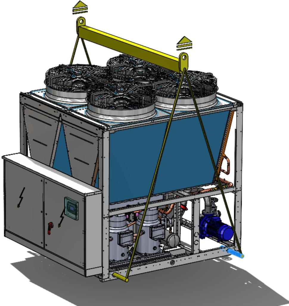
Illustration 1a Procédure de levage correcte Version 2 V
